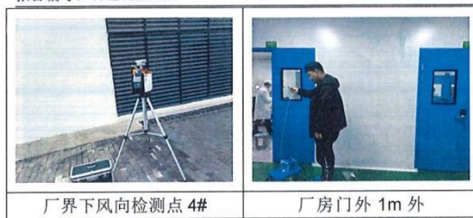
图 3:无组织废气现场采样图
