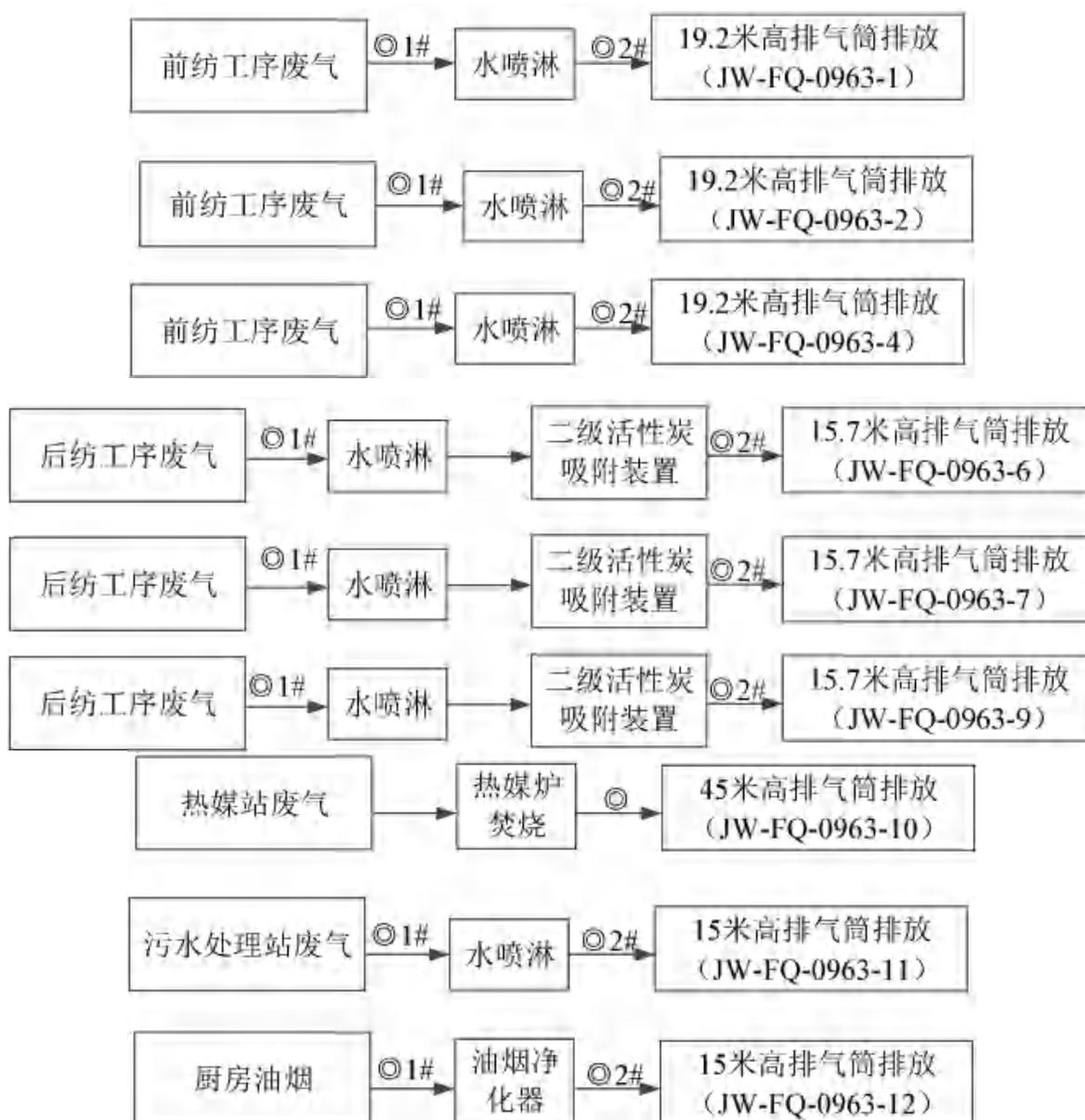
图 4-2 废气处理工艺流程图 ◎表示废气监测点位
