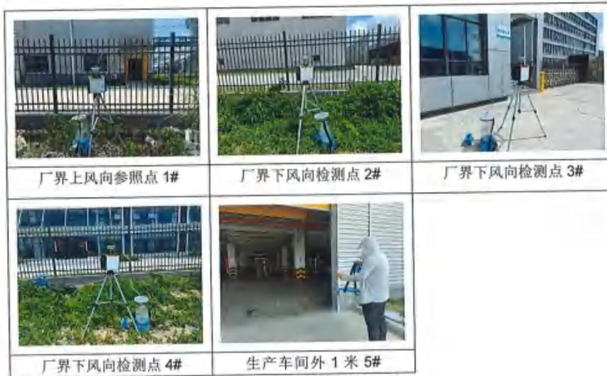
图 11: 无组织废气现场采样图
