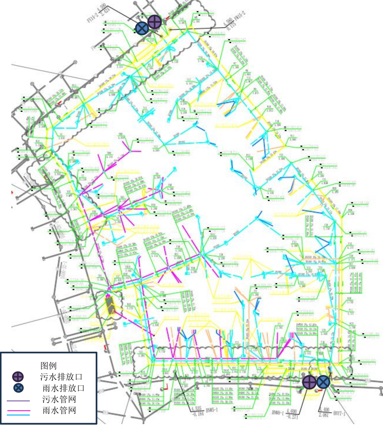
附图 6 项目雨污水管网图
