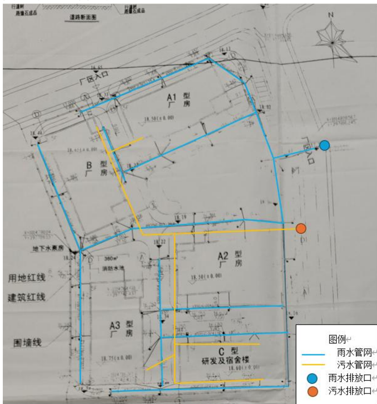
附图 6 项目雨污水管网图
